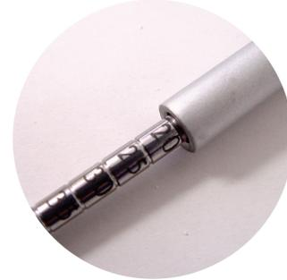
Detalhe da escala do Medidor de Profundidade.
